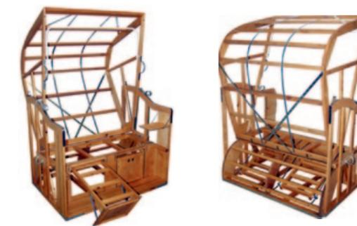
*Korbwerk verwendet ausschließlich durchgehende Leisten in der Rahmenkonstruktion. Alle Hölzer sind offenporig lasiert. Verzinkte Stahlbänder und Beschläge geben zusätzliche Stabilität.*
